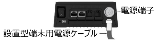
図 3.3 無線機における設置型端末用電源ケーブルの接続
