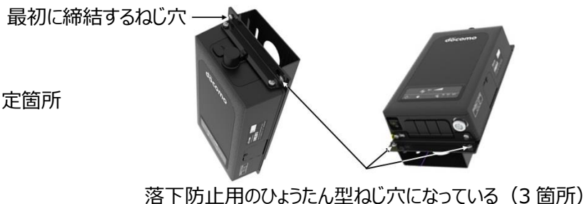
図 4.7 無線機の取付金具への固定方法
