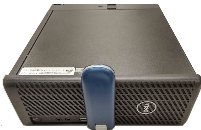
図. LTE 対応 USB ドングル接続後の機器本体（前面）
