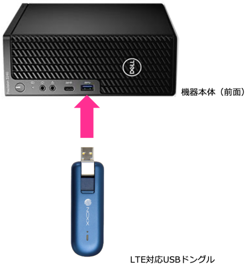
図. LTE 対応 USB ドングルの接続
